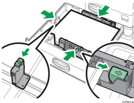
Чтобы зафиксировать торцевую направляющую, совместите два выступа на ограничителе с отверстиями на торцевой направляющей, а затем затяните крепежный винт, повернув его на 90 градусов по часовой стрелке при помощи монетки или аналогичного предмета.
